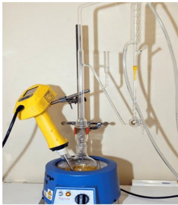
Figura 6: Extracción de aceites esenciales de material vegetal asistida por ultrasonido [62].
